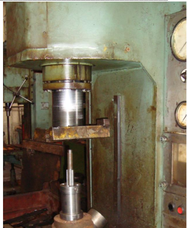
Рис. 4. Експериментальні дослідження з визначення зусилля дорнування напівкруглих канавок шліцевих валів на гідравлічному пресі мод. П6320
