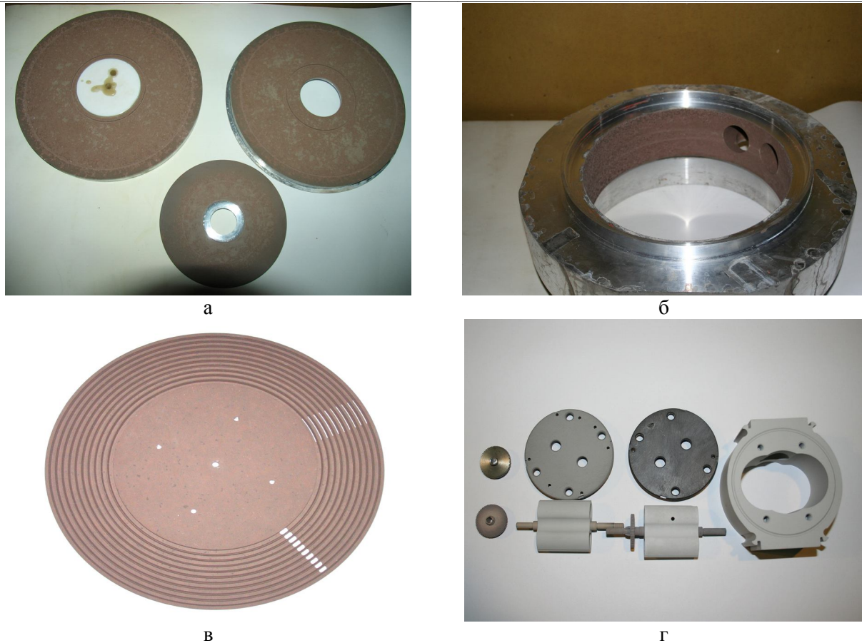
Рис.3. Деталі роторного двигуна (а), сепаратора (б), (в) і газового лічильника (г) з оксидокерамічними покриттями на алюмінієвих сплавах.
