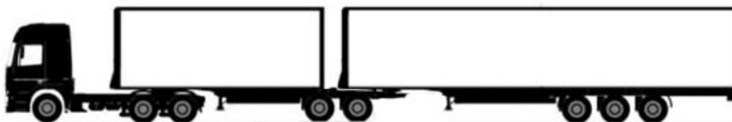
Рис. 1. Схема триланкового автопоїзда типу "B-Double" з винесеним зчипним пристроєм напівпричепу.
