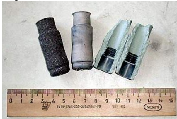
Рис.10 Вогнетривкі керамічні сопла для газового зварювання в захисному середовищі
