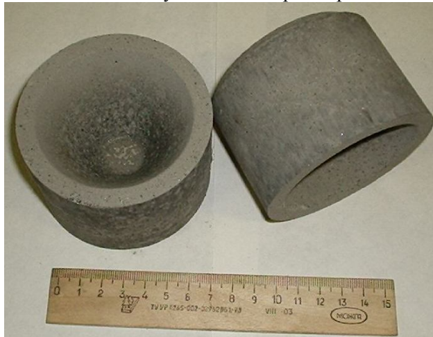
Рис.11 Керамічні тиглі, отримані на основі мулітокорундових композиційних порошкових матеріалів
