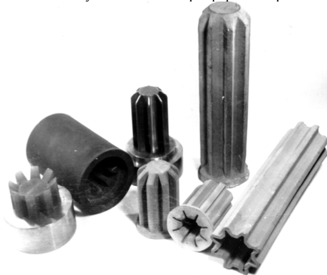
Рис.9 Ребристі фільтри з порошку титану і оснащення для їх пресування
