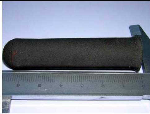
Рис.12 Керамічна довгомірна тонкостінна мембрана (паливний елемент SOFC) у вигляді колби з сферичним дном (товщина стінки 0,4-0,6 мм)
