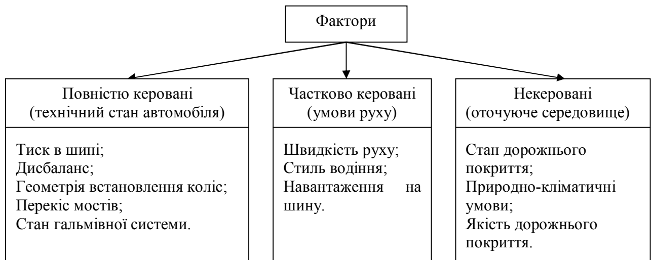
Рис. 1. Фактори, що визначають характер зносу протектора шини
