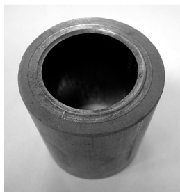
Рис. 1. Втулка, полученная из пористого материала
