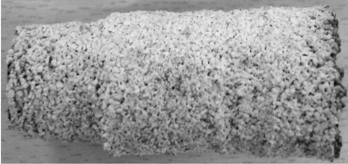
Рис. 2. Сопло пікоструменевої машини виготовлене методом сухого радіально-ізостатичного пресування
