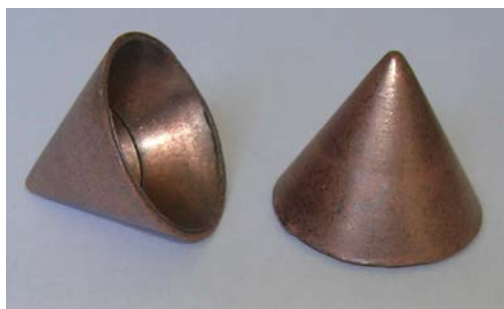
Рис.1. Порошковый тонкостенный конус, полученный холодным методом прессования
