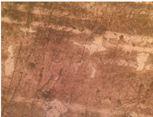
Рис.2 Типова феритно-перлітна структура наплавленого металу в зоні I. X120
