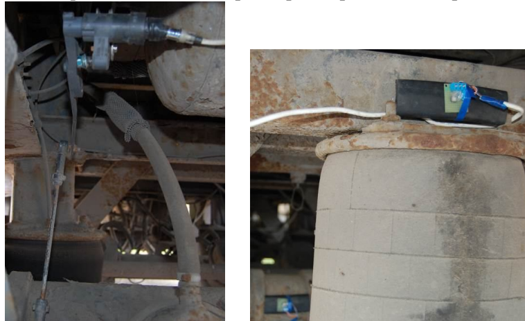
Рис.7. Датчик переміщення і акселерометри закріплені на передній балці автомобіля
