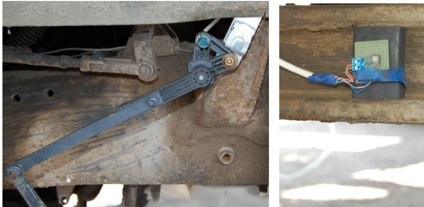
Рис.7. Датчик переміщення і акселерометри закріплені на передній балці автомобіля
