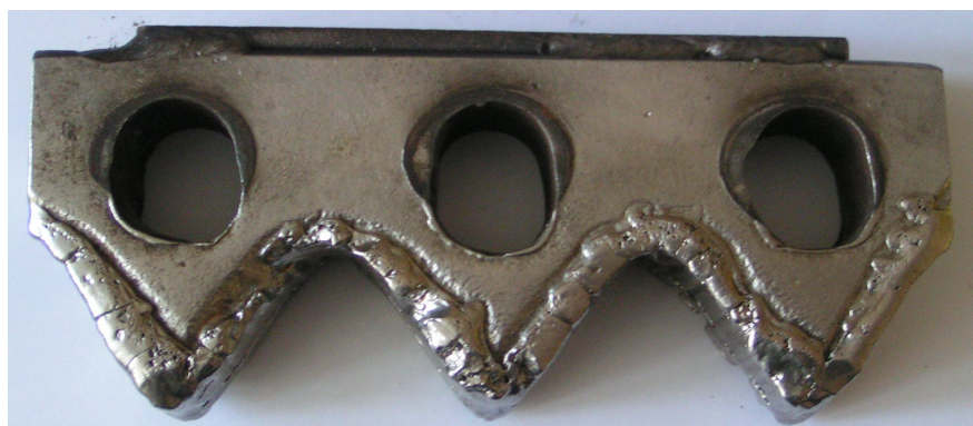
Рис. 1. Ніж до подрібнення автомобільних шин після експлуатації протягом 12 днів
