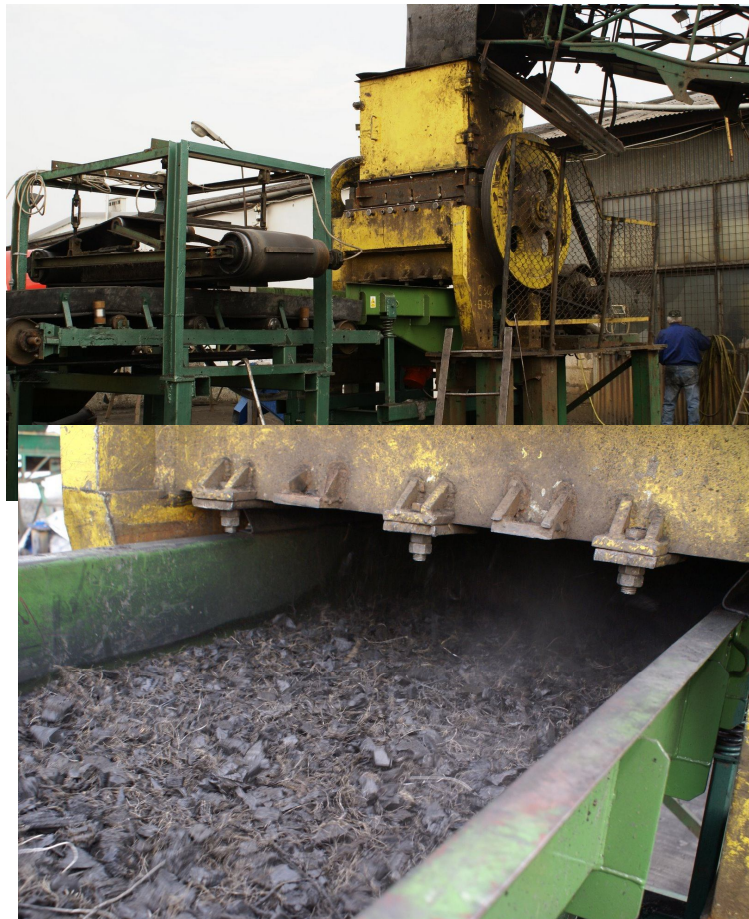
Рис. 2. Третій крок подрібнення автомобільних шин
