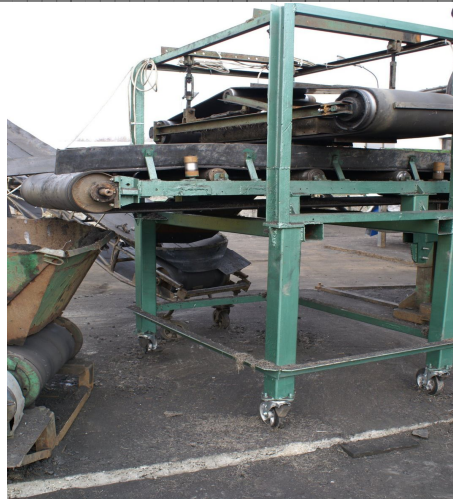
Рис. 3. Система до сепарації сталевих дротів від чіпсів
