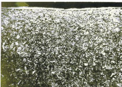
Рис. 5. Мікроструктура поверхневого шару, одержаного на сталі 40X. Склад суміші газів: 94% аміаку; 6% пропан-бутану. Місткість аміаку у відходящих газах - 15%. Режим ХТО: 580 °С; 5 годин. x200.
