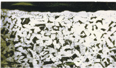
Рис. 3. Мікроструктура поверхневого шару, одержаного на ст.3. Склад суміші газів: 96% аміаку; 4% пропан-бутану. Місткість аміаку у відходящих газах - 10%. Режим ХТО: 570 °С; 5 годин. x200.
