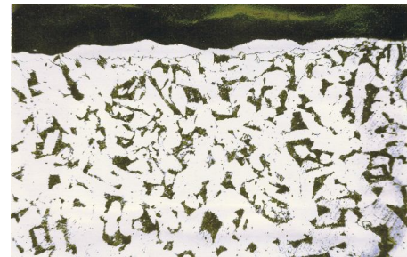
Рис. 4. Мікроструктура поверхневого шару, одержаного на ст.3. Склад суміші газів: 96% аміаку; 4% пропан-бутану. Місткість аміаку у відходящих газах - 10%. Режим ХТО: 570 °С; 6 годин. x200.
