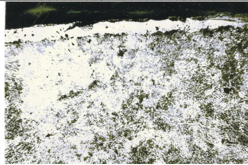
Рис. 8. Мікроструктура поверхневого шару, одержаного на сталі 40X. Склад суміші газів: 100% аміаку. Місткість аміаку у відходящих газах - 20%. Режим ХТО: 580 °С; 5 годин. x200.
