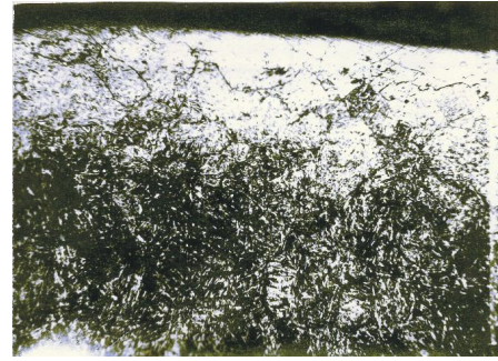
Рис. 14. Мікроструктура поверхневого шару, одержаного на сталі 30X2MЮA. Склад суміші газів: 100%. Місткість аміаку у відходящих газах - 40%. Режим ХТО: 520 °С; 48 годин. x200.
