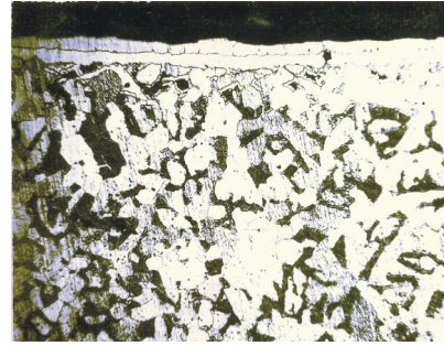
Рис. 2. Мікроструктура поверхневого шару, одержаного на ст.3. Склад суміші газів: 96% аміаку; 4% пропан-бутану. Місткість аміаку у відходящих газах - 10%. Режим ХТО: 580 °С; 3 години. x200
