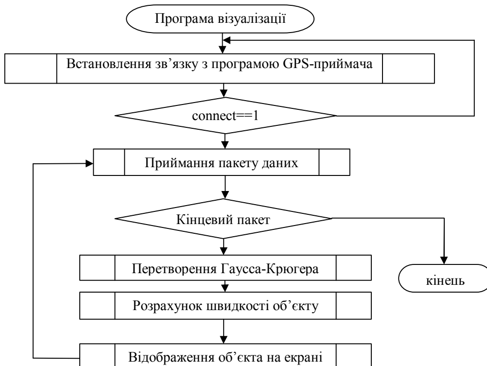
Рис. 2 – Схема алгоритму програми візуалізації рухомого об'єкту
