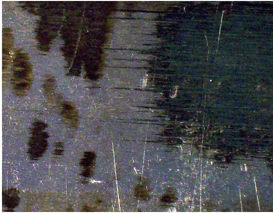
Рис. 6. Прожоги при шліфуванні (зразок пористістю 27,5)
