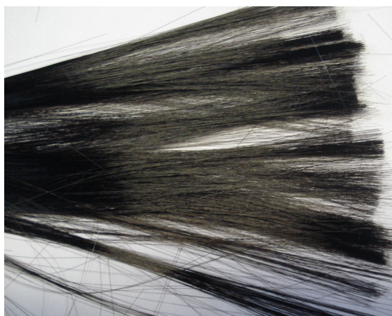
Рисунок 1 – Скло з розплавів гірських порід базальтоподібного складу а) – прозоре скло; б) – волокно діаметром 70-90 мкм
