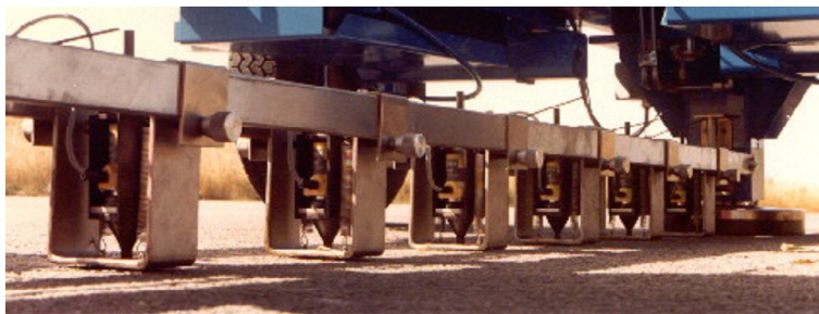
Рис. 1. Датчики переміщень які встановлені на балці
