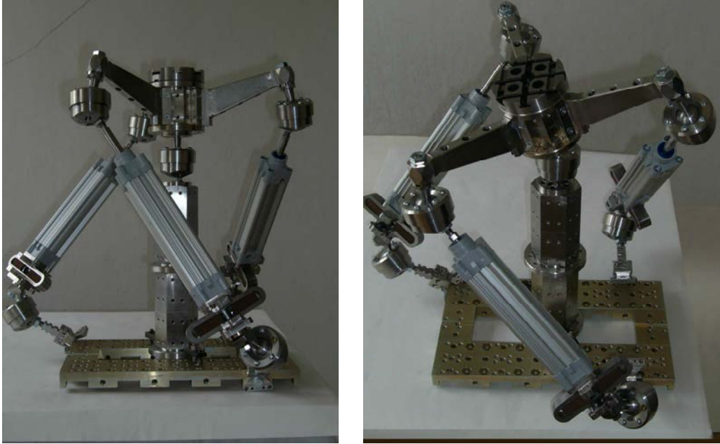
Рис.6. Розроблена просторова система приводів на основі механізму трипода
