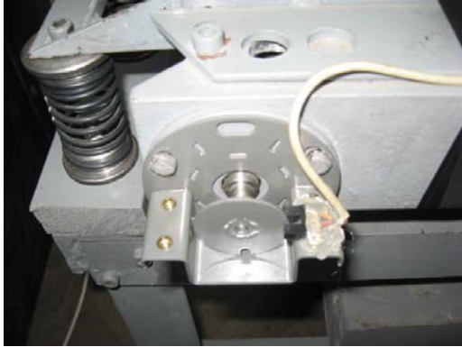
Рис. 3. Щільовий фотодатчик, закріплений біля торця ротора збудника (а); удосконалений пристрій для підсилення ефекту кратної самосинхронізації (б)
