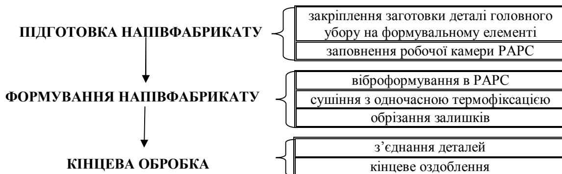
Рис.3. Стадії процесу виготовлення головних уборів
