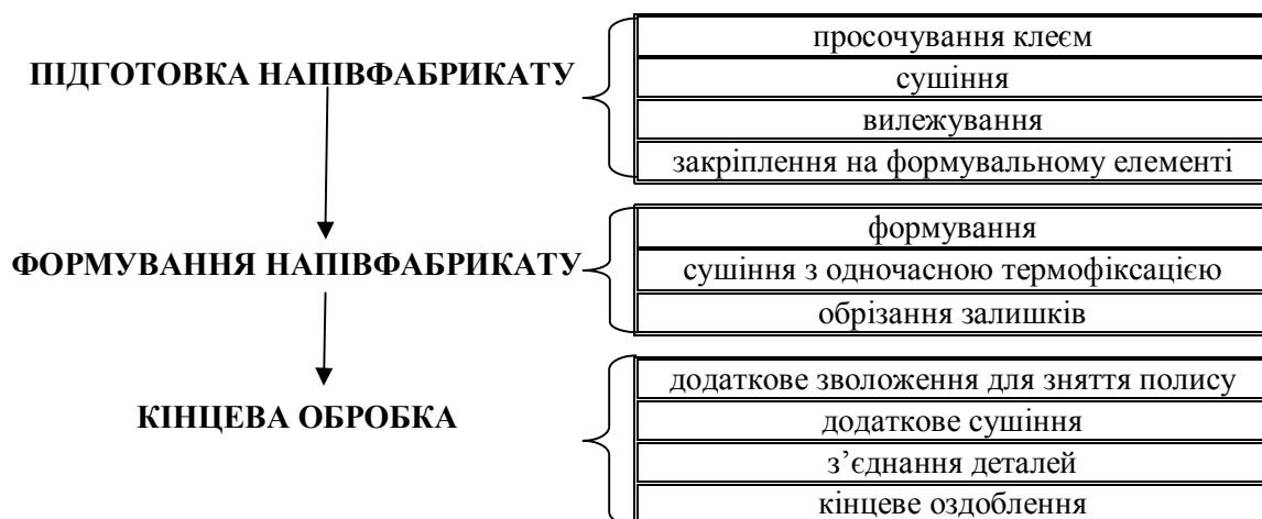
Рис. 1. Стадії процесу виготовлення фетрових формованих головних уборів
