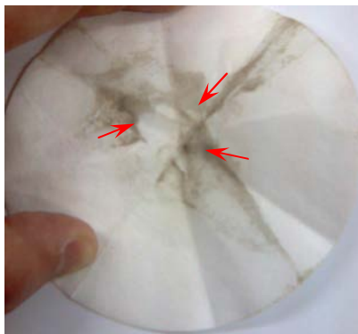
Рис. 1. Следы загрязнений на фильтровальном элементе (отмечены стрелками)
