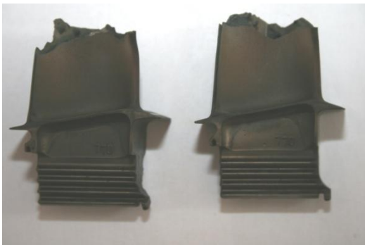
Рис.1. Загальний вигляд лопаток,що обірвалися на двигуні
