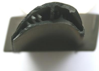
Рис.2. Злам лопатки за місцем руйнування
