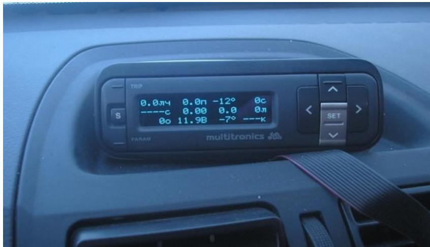
Рис. 1. Бортовий комп'ютер Multitronics МК VC 1031 GPL під час виконання замірів
