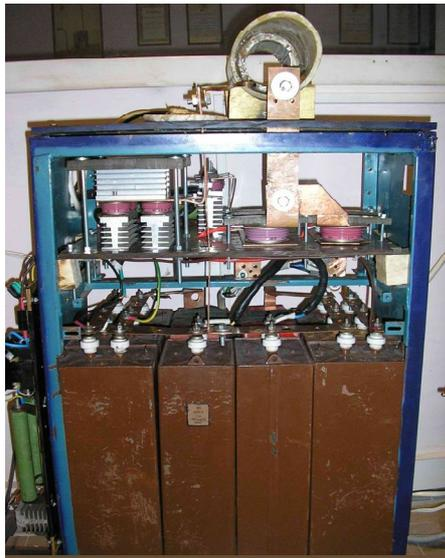
Рис. 2. Источник мощности – Магнитно-импульсная установка МИУС-2
