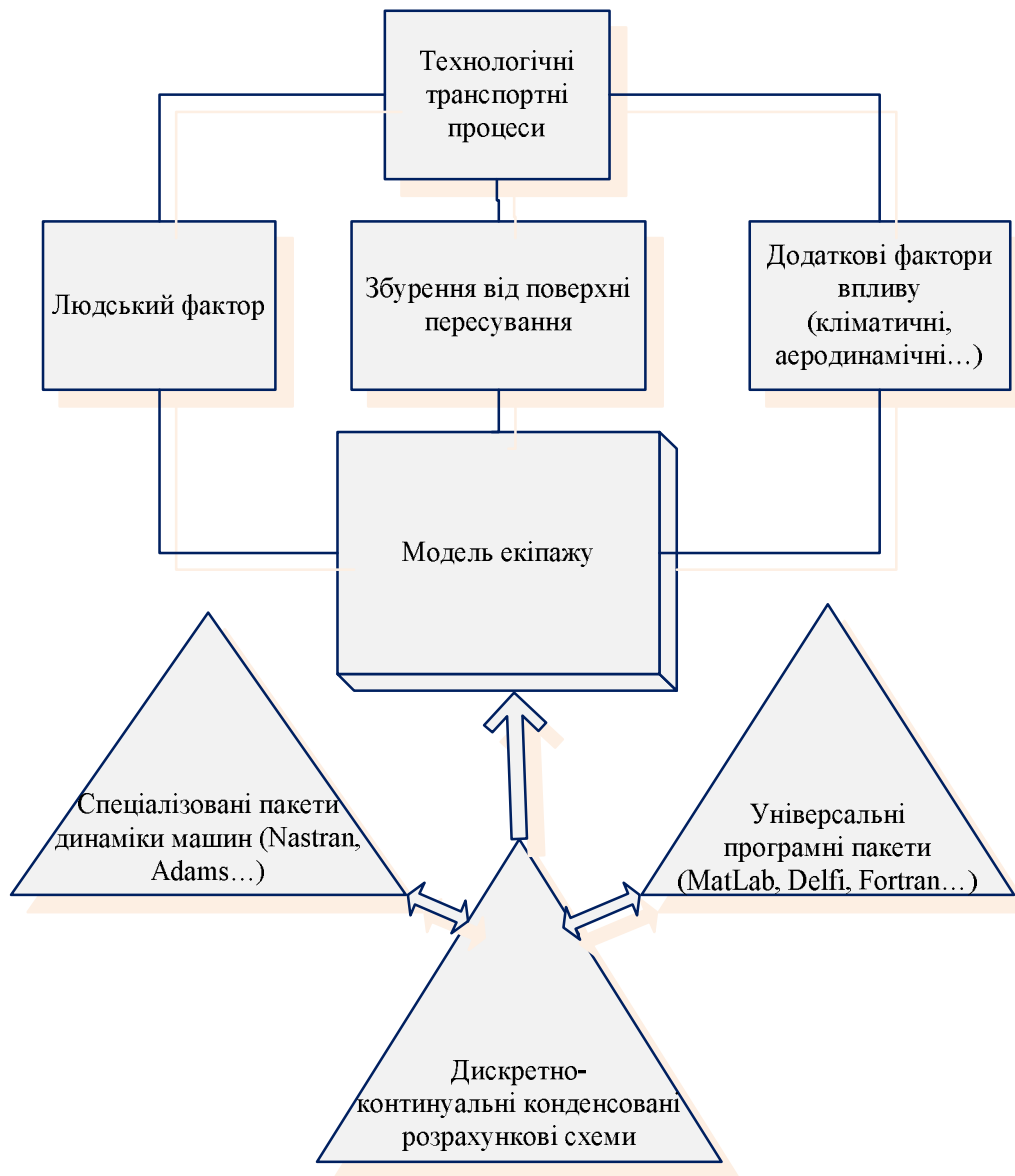
Рис. 3. Схема побудови розрахункової моделі колісного екіпажу
