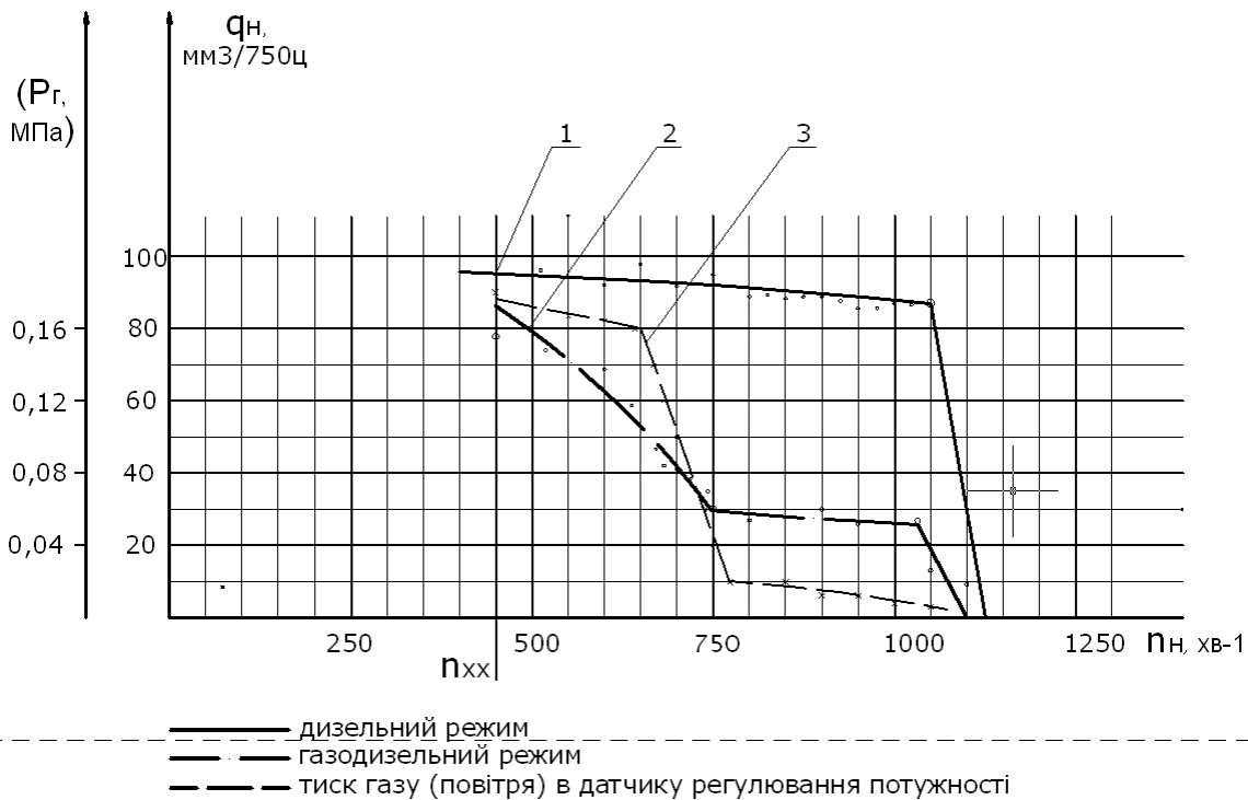
Рис. 2. Зовнішня швидкісна характеристика ПНВТ в режимах „дизель – газодизель” 1- дизельний режим роботи ПНВТ; 2-газодизельний режим роботи ПНВТ; 3-тиск газу (повітря) в датчику регулювання потужності газодизеля.
