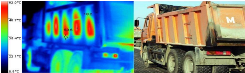
Рис. 3. Неравномерность остывания смеси в кузове автомобиля
