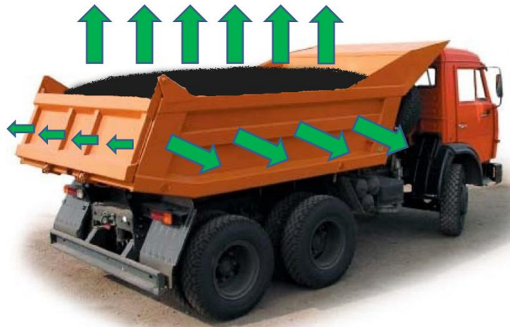
Рис. 2 . Потери тепла из кузова автосамосвала в окружающую среду
