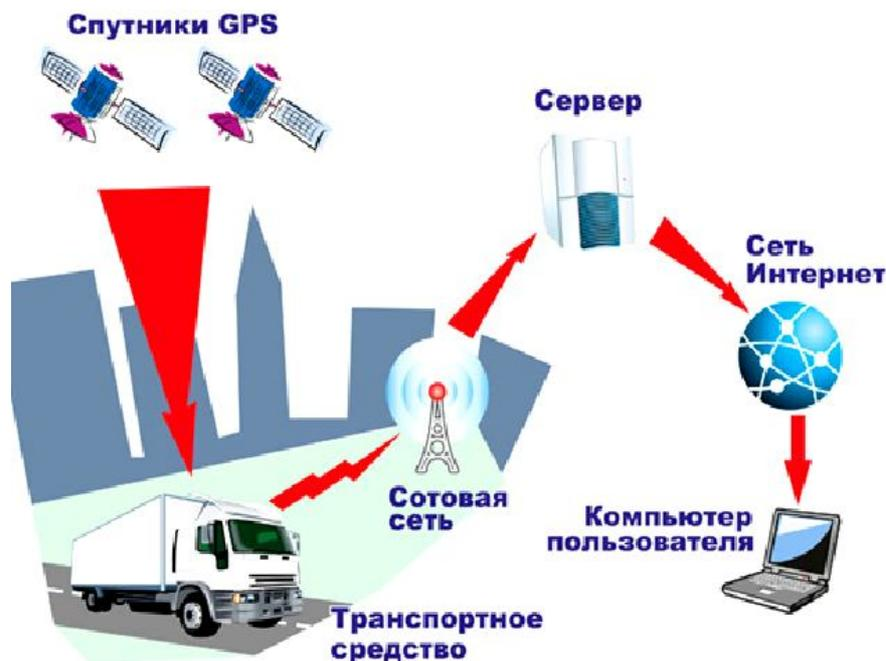
Рис. 1 – Схема взаимодействия элементов системы мониторинга транспорта
