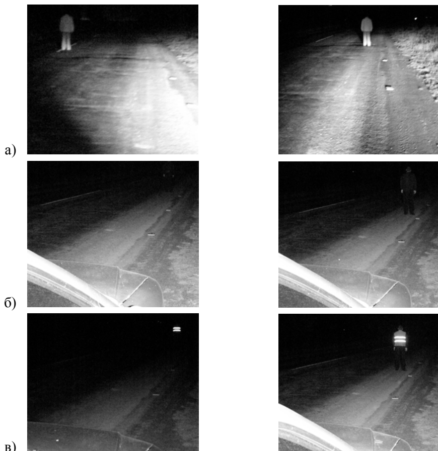
Рис. 4. Проведення експериментів з визначення величини дальності видимості (силуетної та конкретної), враховуючи колір та особливості одягу пішохода, тип і стан дорожнього покриття
