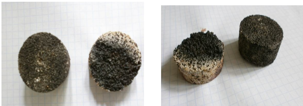
Рис.2. Дослідні зразки випробувані на корозійну стійкість.
