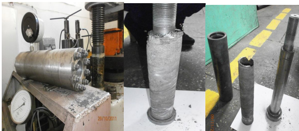
Рис.1. Фільтри виготовлені радіально-ізостатичним методом та спечені за рахунок СВС-реакції.
