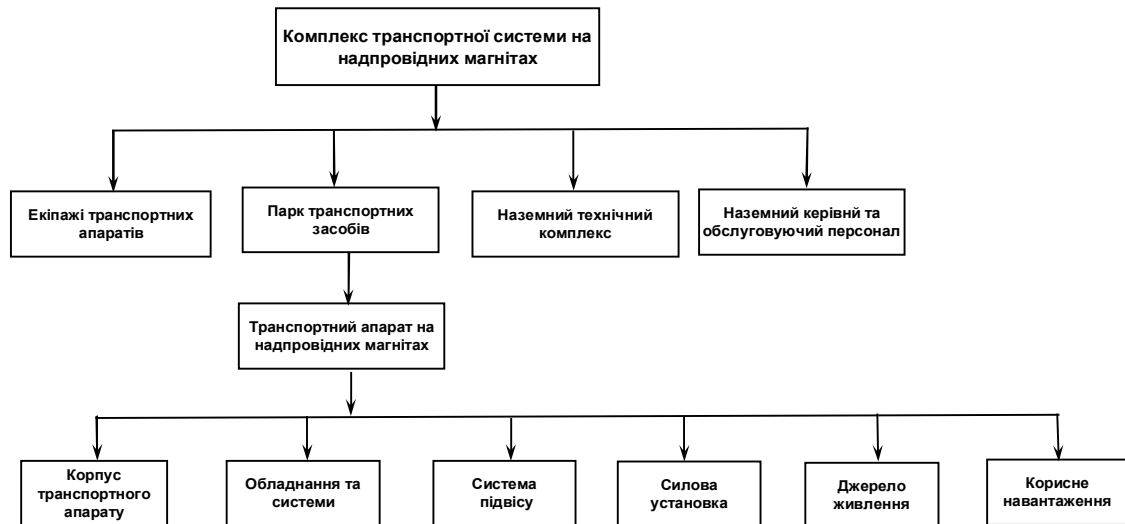
Рис. 3. Структурно – функціональна схема транспортного апарата на надпровідних магнітах в комплексі високошвидкісної транспортної системи
