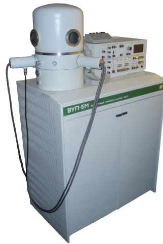
Рис.1 Зовнішній вигляд вакуумного універсального поста ВУП-5М
