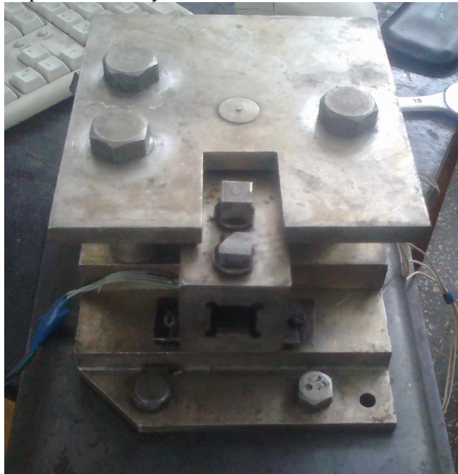
Рис. 2. Трьохкомпонентний динамометр на основі тензодатчиків в зборі
