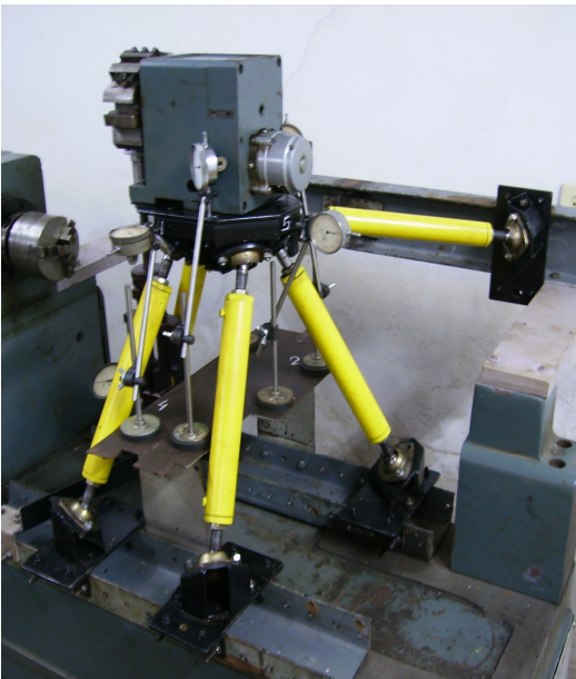
Рис. 1. Дослідний макет супортної системи токарного верстата типу «Гексаглайд»
