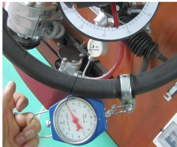
Рис. 4. Замір зусилля яке потрібно прикласти до рульового колеса: 1 - рульове колесо; 2 – динамометр; 3 – кріплення динамометра
