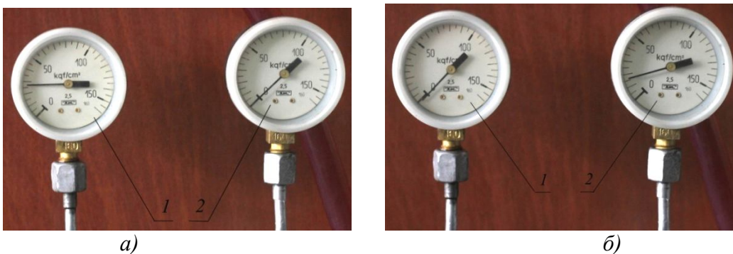
Рис. 2. Покази манометрів при повертанні рульового колеса (1 – манометр лівого контура; 2 – манометр правого контура): а) поворот ліворуч; б) поворот праворуч
