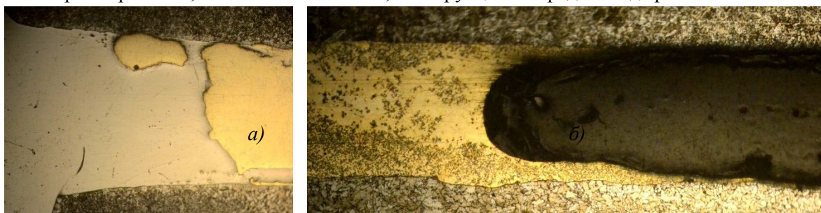
Рис. 5. Границі сплавлення між сталлю і міддю: а) із сторони зварного шва; б) із протилежної сторони від зварного шва [авторська розробка]
