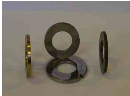
Рис. 1. Деталі модельної пари тертя при схемі контактування кільце-площина
