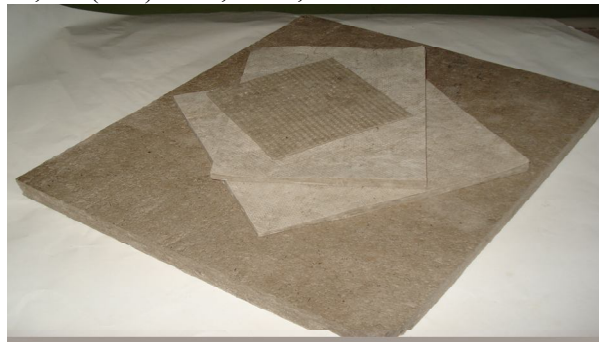
Фото 2. Теплоізоляційні матеріали на основі базальтових волокон
