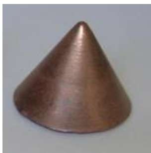
Рис. 1. Облицовка кумулятивного заряда из порошкового гетерогенного материала на основе меди
