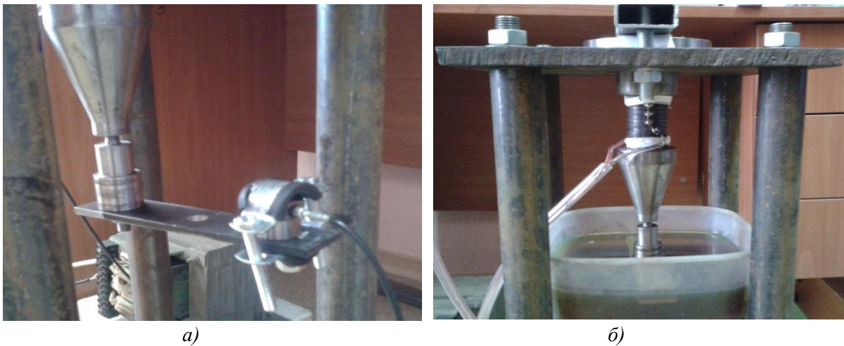
Рис. 2. Обробка алюмінієвої пластини на експериментальній установці для ЗВОПС: а) – вимірювання резонансних частот; б) обробка в індустріальному маслі
