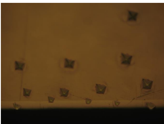
Рис. 3. Мікротвердість зразків зі сталі 45 після комплексної технології при навантаженні 50 г, \times 500
