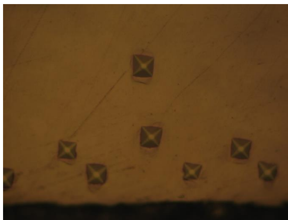
Рис. 2. Мікротвердість зразків зі сталі 45 після вібраційного обкатування при навантаженні 50 г, \times 500
