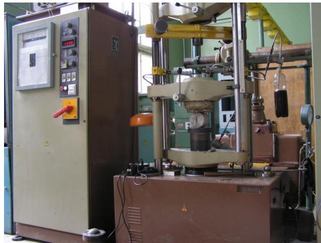
Рис. 3. Лабораторна установка ФМІ для визначення міцності модельних бетонних зразків із штучною тріщиною при деформації стиску
