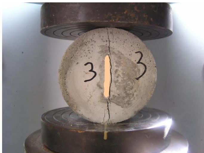
Рис. 4. Лінія поширення тріщини при стиску в бетонному зразку зі штучним концентратором напружень, заповненим твердим ін'єктованим поліуретаном
