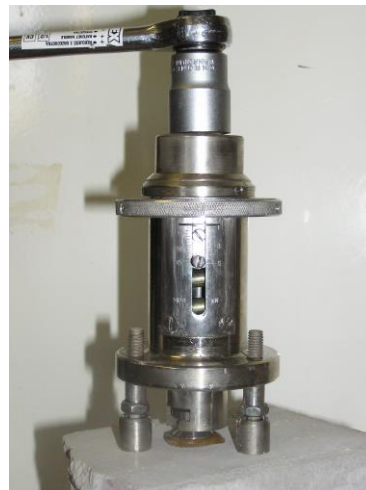
Рис. 9. Конструктивна схема адгезиметра «АДГМ 20-Техно-Ресурс» (зліва) і відрив грибка від поверхні бетонного зразка (справа): 1 – гайка; 2 – барабан; 3 – вальниця; 4 – шпіндель; 5 – пружина; 6 – втулка центрувальна; 7 – корпус; 8 – демпфер; 9 – захоплювач; 10 – грибок; 11 – ніжки; 12 – втулки; 13 – гвинти; 14 – шпонка; 15 – кільце; 16 – фіксатор; 17 – лінійна шкала; 18 – бобіна; 19 – лімба шкала
