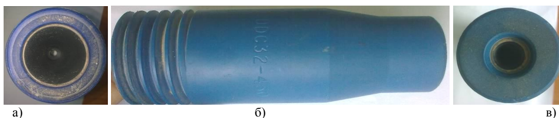
Рис. 2. Абразивоструменеве сопло UDC32–450 форми Вентурі а) вхідна широка горловина; б) вид збоку; в) вихідна вузька горловина
