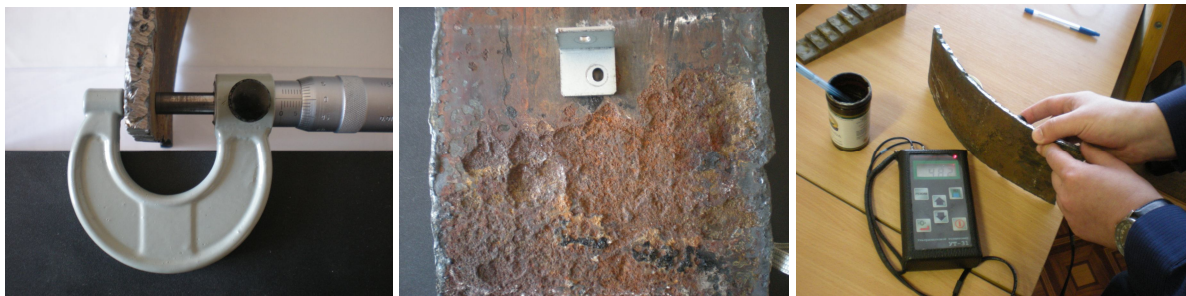
Рис. 7. Визначення розмірів корозійних втрат металу труби контрольованої ділянки (по центру) за допомогою мікрометра моделі 102 (некородовані ділянки) та ультразвукового товщиноміра УТ-31 (кородовані ділянки)
