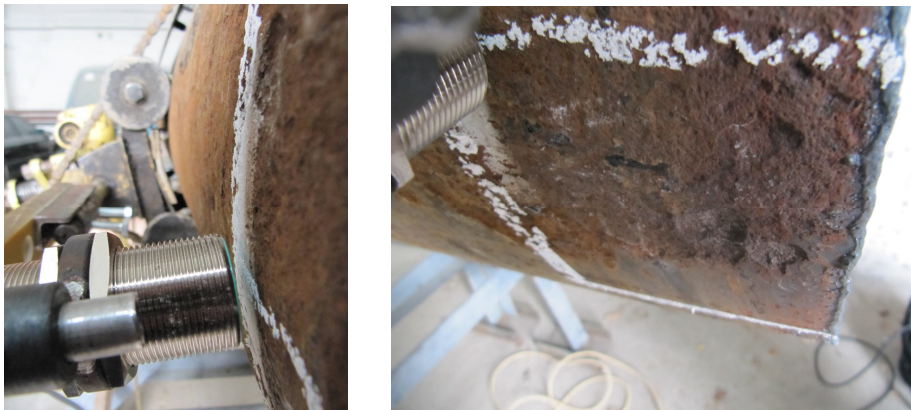
Рис. 5. Індуктивний давач втрат металу в процесі контролю без ізоляції та контрольована частина кородованої ділянки труби
