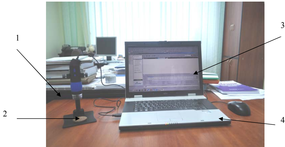
Рис. 2. Оптико-програмний комплекс Micro-optik для визначення морфології та структури матеріалів: 1 – мікроскоп eScore; 2 – шліф досліджуваного матеріалу; 3 – інтерфейс програми Smart-eye; 4 – персональний комп'ютер
