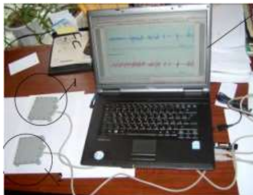
Рис. 3. Мобільний вимірювальний комплекс, розроблений кафедрою технології машинобудування і ремонту машин ХНАДУ: 1, 2 – акселерометри; 3 – ноутбук
