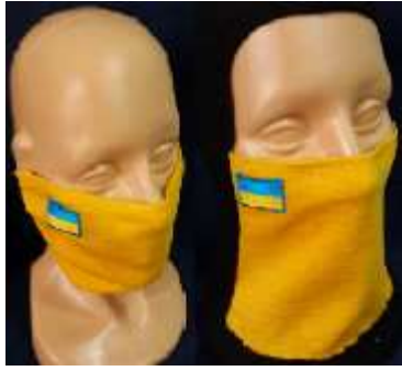
Рис. 1. Виготовленні зразки текстильних респіраторних масок на основі двощарового трикотажу
