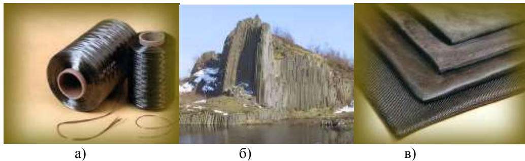
Рис. 1. Базальт та вироби з нього: а) базальтовий ровінг, б) базальтова скала, в) тканина з базальтового волокна
