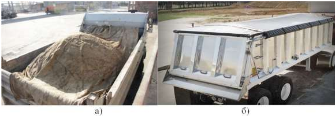
Рис. 2. Використання тенту для теплоізоляції асфальтобетонної суміші під час транспортування: а – малоефективний спосіб, б – ефективний спосіб
