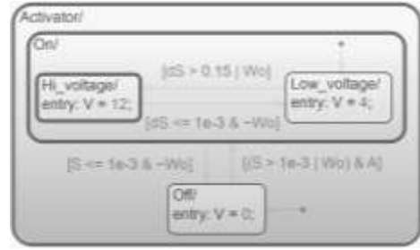
Рис. 5. Структурна Stateflow модель логічного контролера (рис. 4, поз. 9).
