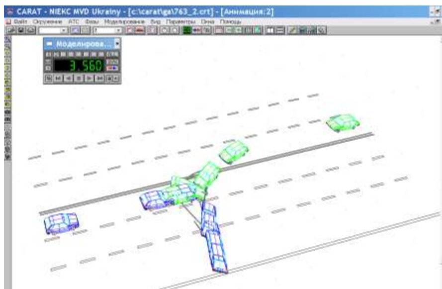
Рис. 7. Повний механізм зіткнення транспортних засобів (3D-анімація)
